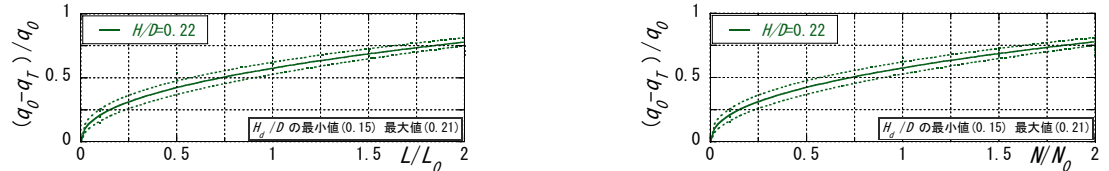
図-9 もぐり越流状態での乙津川の越水氾濫流量の低減率(左: 樹林帯幅 L の効果 右: 樹木本数 N の効果)
